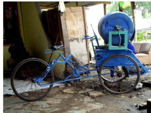
*Gambar 1. Alat pencuci berbentuk drum*
