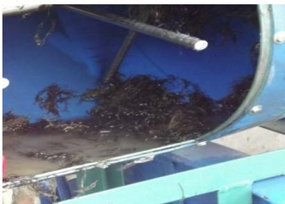
Gambar 2. Bagian dalam drum pencuci
