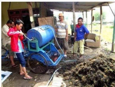
Gambar 3. Pencucian rumput laut dengan drum pencuci
